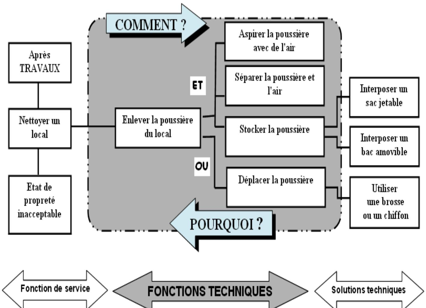
Exemple d'un aspirateur ou d'un balai mécanique :
