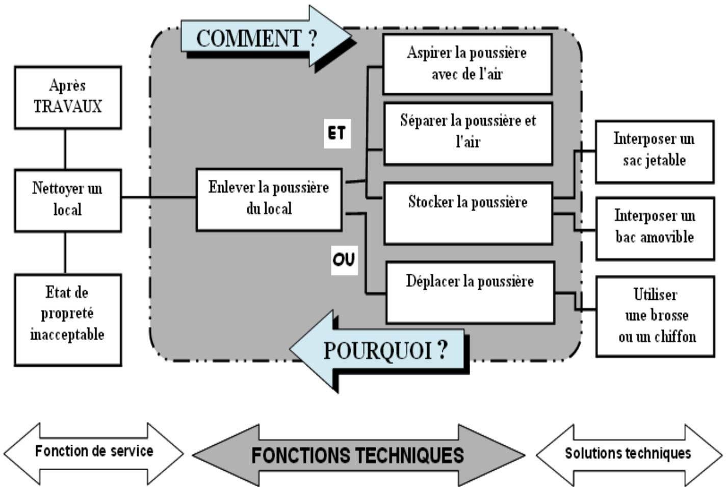
Exemple d'un aspirateur ou d'un balai mécanique :
