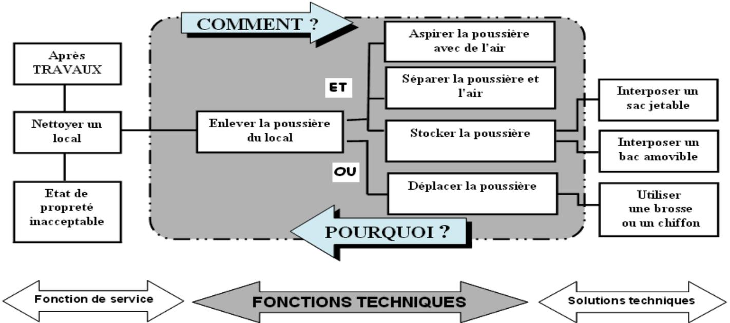
Exemple d'un aspirateur ou d'un balai mécanique :
