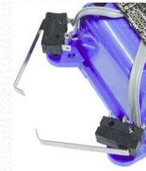
✓ 2 capteurs (micro rupteurs) détectent la présence d'un obstacle à gauche ou à droite.
