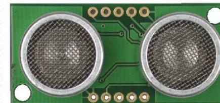
Le module permet de détecter un plot de 3 cm de diamètre et quelques cm de haut à une distance comprise entre 3 cm et 2,55 m.
