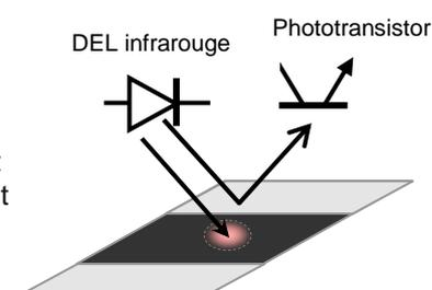
Un résistance ajustable (VR1) sur le dessus du module permet de régler la sensibilité du capteur. Des DEL témoins jaunes permettent de visualiser quel phototransistor est activé.
