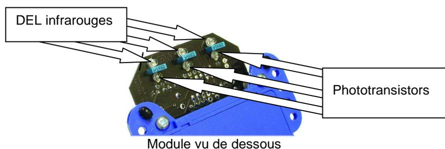
Les 3 DEL émettent un rayonnement infra rouge qui sera absorbé par un Marquage noir au sol ou bien au contraire sera réfléchi par des zones claires. Les phototransistors associés à chaque DEL détectent ou non le rayonnement infrarouge. Les 3 DEL et les 3 phototransistors sont indépendants et permettent de déterminer avec précision la position de votre robot par rapport à une ligne noire tracée au sol.
