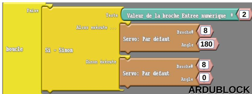
L'appui sur BP(entrée2=1/haut) , actionne dans un sens (angle180) le Servo (sortie8), sinon sens inverse (angle0)
