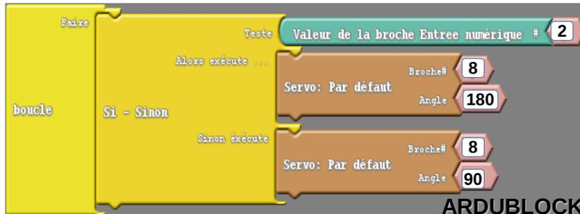
L'appui sur BP(entrée2=1/haut) , actionne dans un sens (angle180) le Servo , sinon ne tourne pas (angle90)
