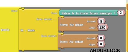
Quand le capteur IR touche la ligne (entrée2=1/haut), s'actionne le Servo (sortie8) dans un sens (angle180), sinon sens inverse (angle0)
